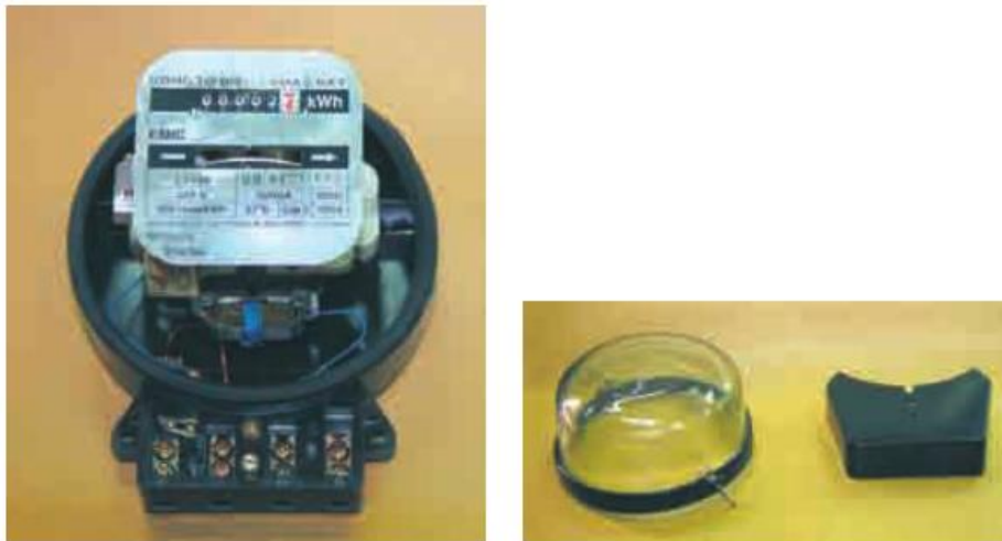
Hình 4 - 1. Công tơ điện.
